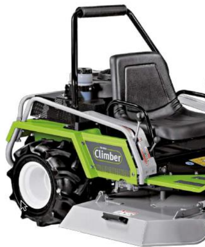
Le ruote anteriori sono dotate di trattamento antiforatura per lavorare negli ambienti più ostili! Climber 9.18 con motore Intek 7180
