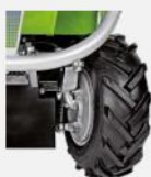
Particolare protezioni antierba
